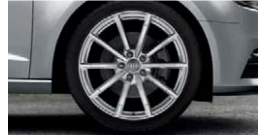
10 kol tasarımı Audi exclusive alüminyum döküm jantlar 7,5 J x 18 ebadında 225/40 R 18 lastiklerle 1 . quattro GmbH sunumudur.
