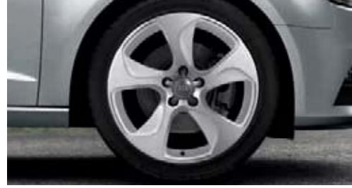
5 kollu dinamik tasarımlı alüminyum döküm kış jantları 7,5 J x 18 ebadında 225/40 R 18 lastiklerle 1 , izin verilen azami hız 240 km/h, kar zincirine uygun değil
