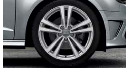
5 paralel kollu tasarımı alüminyum döküm jantlar (S tasarımı) Kısmen parlatılmış, 7,5 x 18 ebadında 225/40 R 18 lastiklerle 1
