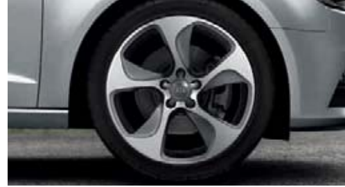
5 dinamik kol tasarımı alüminyum döküm jantlar antrasit, kısmen cıvalı, 7,5 J x 18 ebadında 225/40 R 181 lastiklerle 1
