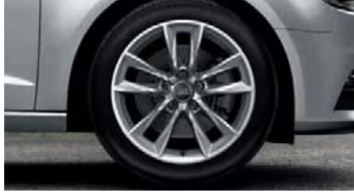
5 kollu kinetik tasarımı alüminyum döküm jantlar 7,5 J x 17 ebadında 225/45 R 17 lastiklerle 1 (Opsiyonel olarak acil durum lastikleriyle)
