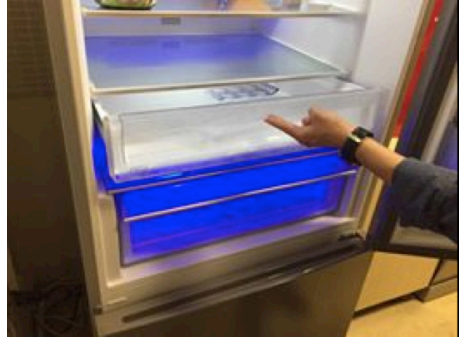
Şekil 4. Kaldırma işleminden sonra, ikinci kat sebzelik şekil 5'te görüldüğü gibi, ikinci stopere kadar çekilmelidir.
